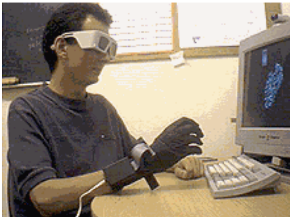
Figura 1. Sistema de ambientes virtuales para visualizar archivos en formato VRML. (Foto: Cortesía del Laboratorio de Ambientes Virtuales, Universidad de Sussex.)
