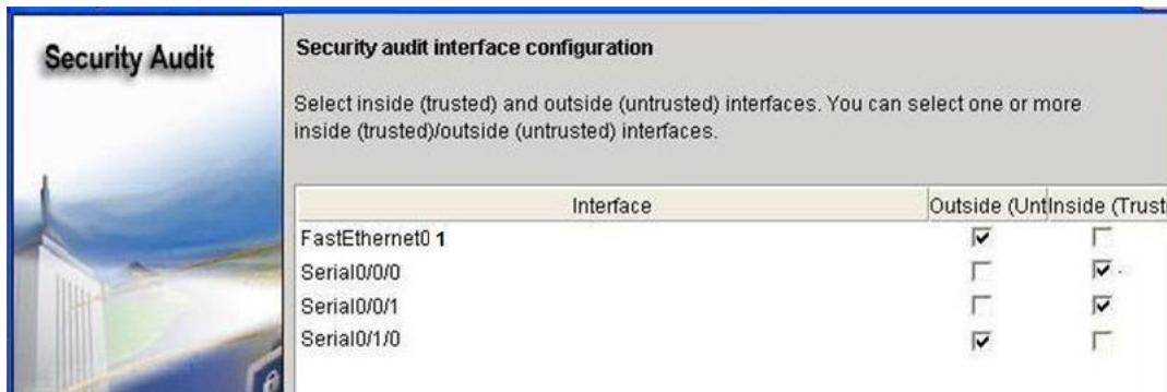
Si el usuario no está seguro acerca de la legitimidad del tráfico que ingresa a la interfaz, ésta debe calificarse como externa (no confiable). En este ejemplo, ni FastEthernet0/1 ni Serial0/1/0 son confiables porque Serial0/1/0 apunta a Internet mientras que Fastethernet0/1 apunta al acceso de la red y podría generarse tráfico ilegítimo.
