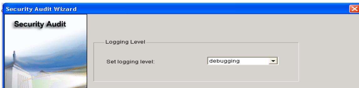
A continuación, establezca el nivel de gravedad de los traps de registro que el router debe enviar al servidor syslog. El nivel de gravedad se establece en depuración para esta situación. Haga clic en **Next** para ver un resumen de los cambios que se realizarán en el router.
