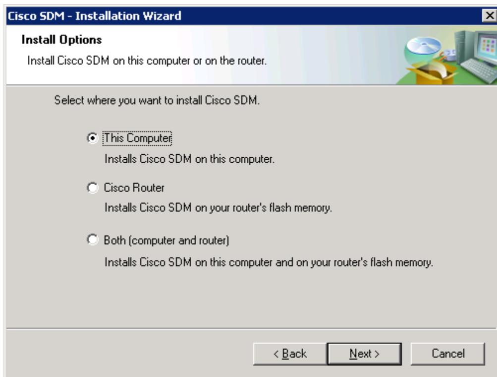
Al instalar SDM, se puede instalar la aplicación en el equipo sin colocarla en la memoria flash del router, se puede instalar en el router sin afectar al equipo o bien se puede instalar en ambos. Ambos tipos de instalaciones son muy similares. Si se desea instalar SDM en el equipo, vaya directamente al paso 7.
